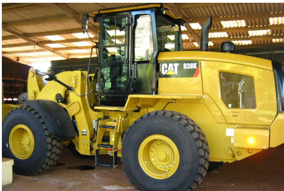
Figura 11: Vista lateral da Pá Carregadeira Caterpillar 938K
