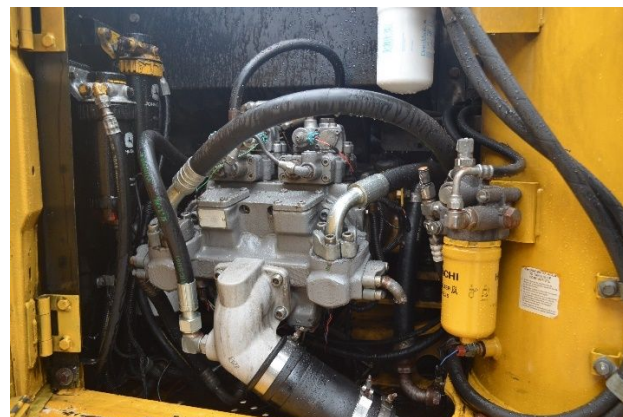
b) Sistema hidráulico da Deere 160D LC
