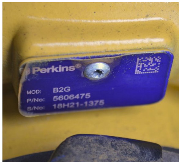
b) Detalhes do fabricante do motor no turbo compressor
