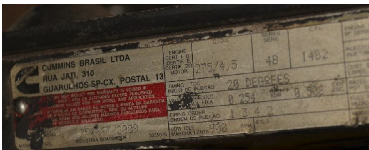
Figura 21: Plaqueta do fabricante do motor da Retroescavadeira Case 580M turbo
